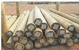
Todos os itens deverão ser compostos por Toras, Terças e Caibros de Eucalipto tratado, conforme ABNT NBR 14806:2002.
