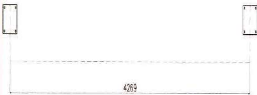
Locação das fundações do abrigo
